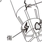
白錆が発生し、アンカー設置・撤去時に不具合が発生する
