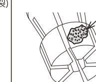
ねじ部の破損や汚れ、異物の付着が原因で、内部コーンの挿入量が不足し、強度不足になる
