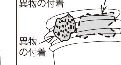
ねじ部の汚れや異物の付着により、内部コーン締付け時の抵抗となり、締付け不良となる恐れがある
