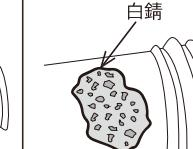
白錆が発生し、アンカー設置・撤去時に不具合が発生する
