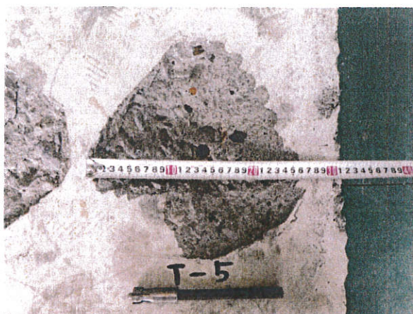
写真-6 破壊状況 試験体記号：T-5 最大荷重：25.9kN A：コーン状破壊
