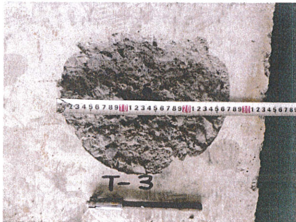
写真-4 破壊状況 試験体記号：T-3 最大荷重：27.6kN A：コーン状破壊
