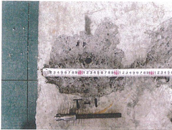
写真-2 破壊状況 試験体記号：T-1 最大荷重：25.8kN A：コーン状破壊
